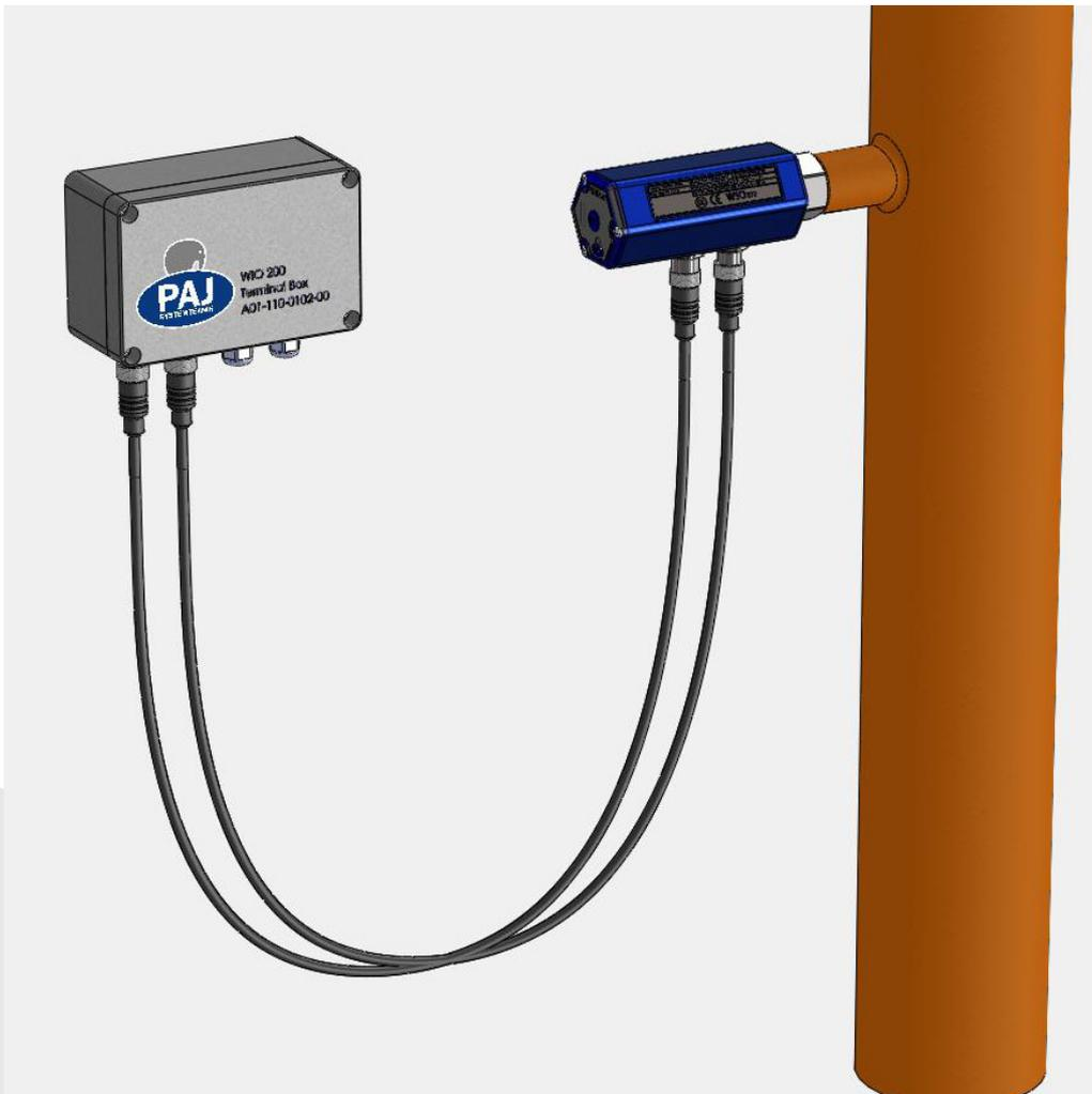
Die Sonde kann mittels ISO 228-1 G  $\frac{3}{4}$ " Gewinde druckdicht in der Mitte der Ölleitung installiert werden. Das Gewinde muss mit Loctite® 271 abgedichtet und mit einem maximalen Drehmoment von 35 Nm angezogen werden.
